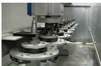
MAGAZZINO PORTA UTENSILI A 10 POSIZIONI TOOL STORAGE FRAME WITH 10 POSITIONS
