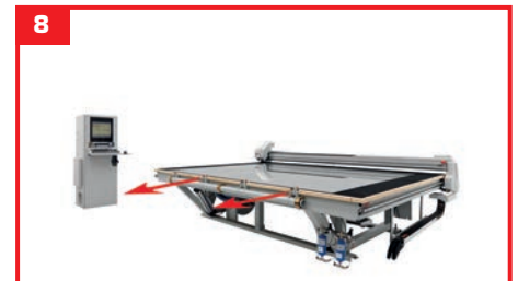
8 I piedini a scomparsa si riposizionano automaticamente in posizione di sicurezza per inizio taglio. The drop-down feet automatically move back to their safety position for the cut cycle start.
