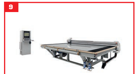
9 La testa operatrice comincia automaticamente il ciclo di taglio. The operating head automatically begins the cutting cycle.
