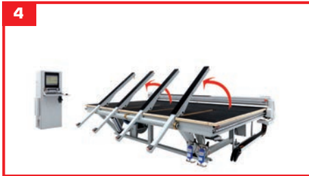
4 I bracci della ribaltina si mettono automaticamente in posizione di carico. The tilting arms automatically reach the loading position.
