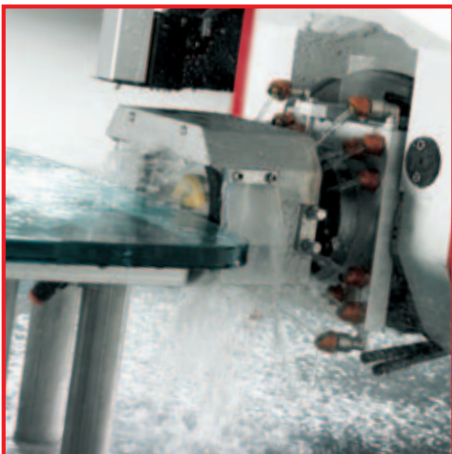
Molatura filo lucido a tazza. Edge polishing with cup wheel.
